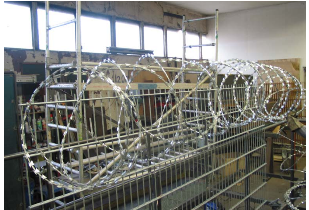
Befestigung Natodraht an Gitterzaun mit Edelstahl C-Klammern, Rollendurchmesser 450 mm
