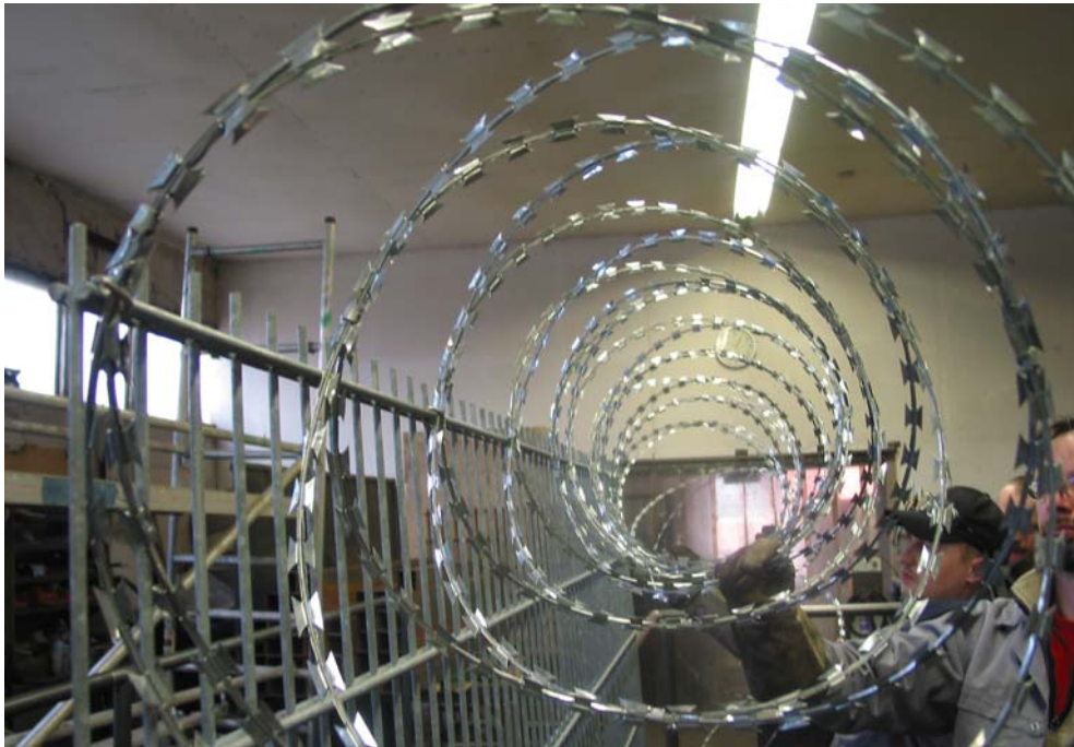
Befestigung Natodraht an Gitterzaun mit Edelstahl C-Klammern, Rollendurchmesser 450 mm
