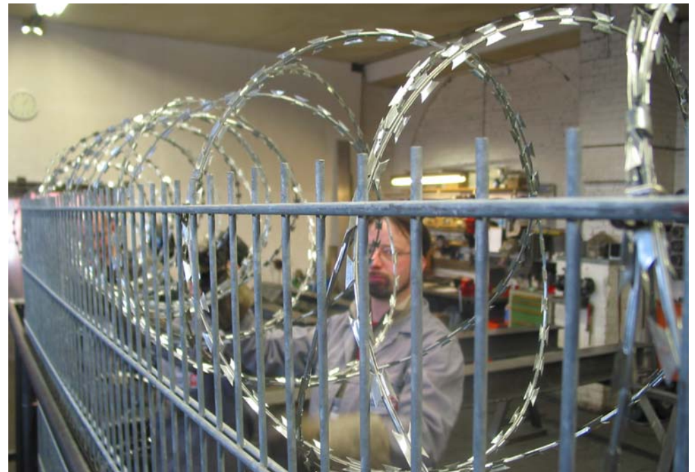
Befestigung Natodraht an Gitterzaun mit Edelstahl C-Klammern, Rollendurchmesser 450 mm
